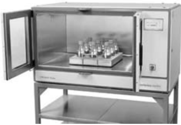
III. 1 : Agitateur-incubateur spécialisé dans la culture de cellules de mammifères
